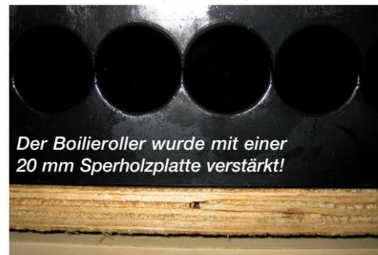
Der Boilieroller wurde mit einer 20 mm Sperrholzplatte verstärkt!
